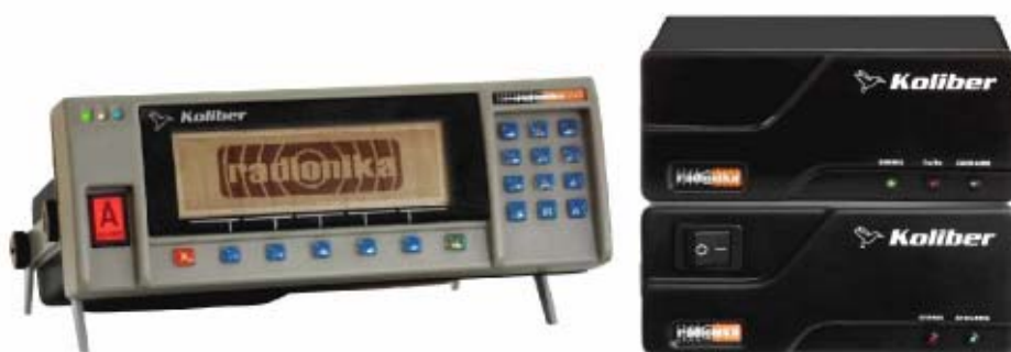
Rys.1 Kompletny zestaw urządzeń wchodzących w skład radiotelefonu
