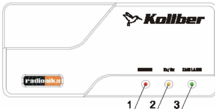
Rys.4 Panel czołowy modułu N-O
