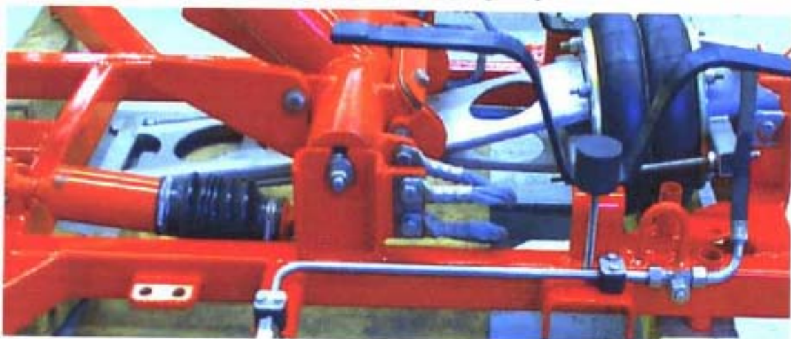
Rys. 5.9. Mechanizm napędu odbieraka prądu DSA150-PKP
