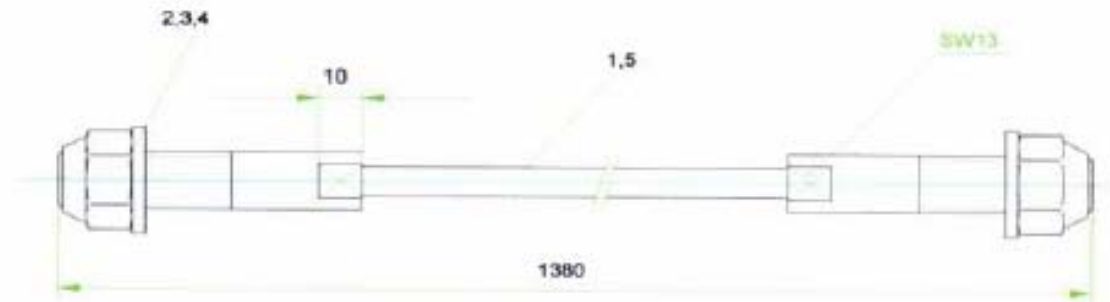
Rys. 5.14. Linka napędu pneumatycznego odbieraka prądu
