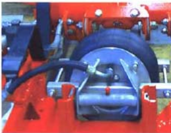
Rys. 5.7. Mechanizm napędu pneumatycznego odbieraka DSA150-PKP
