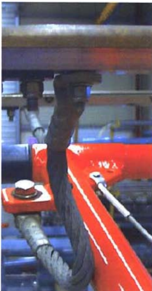
Rys. 10.9 Połączenia elektryczne (łączniki bocznikujące) ślizgacza
