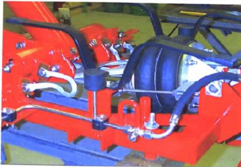
Rys. 10.4 Zamocowanie mechanizmu napędu w ramie wsporczej
