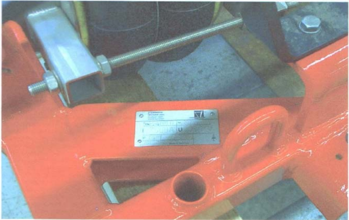
Rys. 14.2 Zaczep do podnoszenia odbieraka DSA150-PKP
